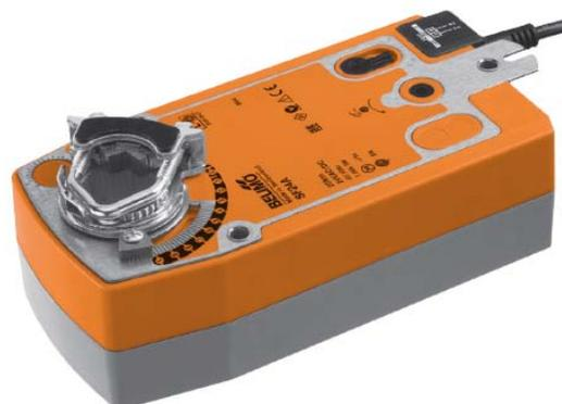
SFA シリーズのダンパー・モータはダンパーを直接駆動で二位置制御あるいは比例制御するスプリング・リターン機構を内蔵するモータです。スプリング・リターン機構はモータへの供給電源が遮断されたとき動作します。
